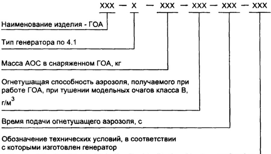
Пример условного обозначения генератора, применяемого в стационарных системах объемного аэрозольного пожаротушения, второго типа (образующего при работе огнетушащий аэрозоль с температурой от 130 до 500 °С), с массой заряда АОС в снаряженном генераторе 2,0 кг, огнетушащей способностью аэрозоля, получаемого при работе ГОА, при тушении модельных очагов класса В равной 47 г/м<sup>3</sup>, временем подачи огнетушащего аэрозоля 30 с, по ТУ 4854—003—07509209.
